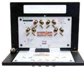
Edge Rate® Differential Pair Edge Card (HSEC8-DP)
